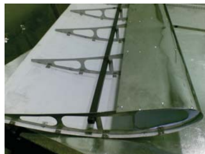
Рис.2. Крыло ветрогенератора (на основе профиля Жуковского)
