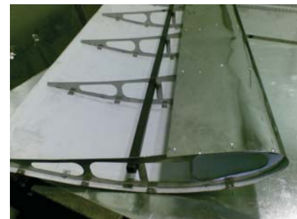
Рис.2. Крыло ветрогенератора (на основе профиля Жуковского)
