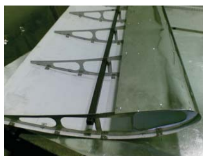
Рис.2. Крыло ветрогенератора (на основе профиля Жуковского)
