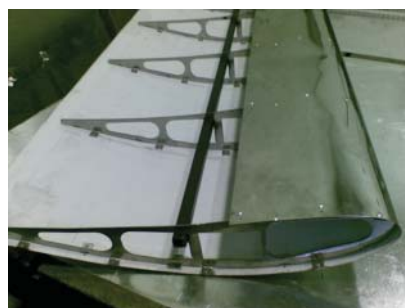
Рис.2. Крыло ветрогенератора (на основе профиля Жуковского)
