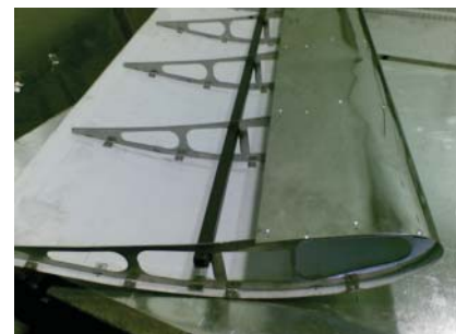
Рис.2. Крыло ветрогенератора (на основе профиля Жуковского)
